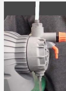
Mangueira de descarga de reserção garantindo que o mesmo esteja conectado à válvula de injeção e reiniciar a bomba.
