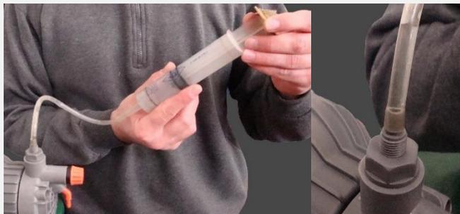
Feche a válvula de sangramento do ar da cabeça da bomba. Inicie os pulsos da bomba acima da taxa de 50% e comece a sugar com seringa até que o líquido suba constantemente na mangueira de seringa em seguida, pare a bomba e tire a mangueira de seringa.
