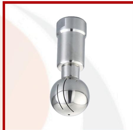
Seu diferencial está na cabeça rotativa, acionada pelo próprio fluxo da solução de limpeza. Esse mecanismo permite a emissão de jatos direcionados que alcançam uniformemente todas as superfícies internas do tanque ou reator. O impacto oscilante gerado pelos jatos proporciona uma limpeza completa e abrangente, eliminando resíduos e contaminantes mesmo nas áreas mais difíceis de alcançar.
